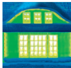
Après la rénovation: pertes énergétiques réduites avec les profilés pour fenêtres GENE ® .
