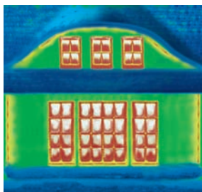
Avant la rénovation: vieux châssis en bois. La chaleur s'échappe notamment par les fenêtres (en rouge sur l'illustration).
